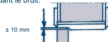
La fente ne doit pas être réalisée entre l'encadrement et le mur car cela risque de provoquer des dépôts. Il est conseillé de réaliser une chicane afin d'empêcher le filet de lumière de passer !
