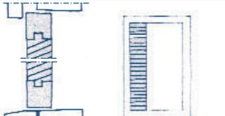
Cette solution nécessite la prise de certaines précautions ; en effet, l'amenée d'air est réalisée en partie sous une hauteur de 1,80 m ce qui est déconseillé par la norme (sensation de courant d'air), sauf s'il est prévu un radiateur en allège ou si l'aérateur n'est ouvert que sur la partie située à plus de 1,80 m.
