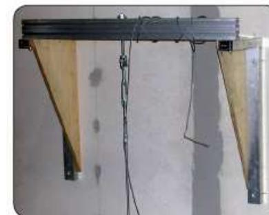
Fig. 5 - Dispositif d'essai pour l'évaluation de la résistance à une charge verticale excentrée.
