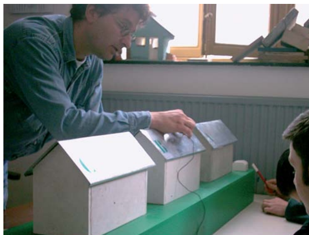
Avec la sonde de contact, mesure des températures sur les toitures puis sur les murs.
