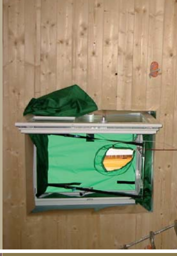
Contrôle de l'étanchéité à l'air par test d'infiltrométrie
